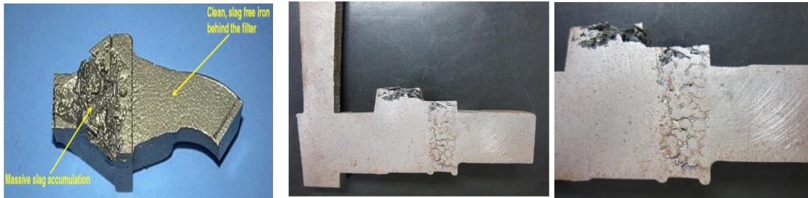
Fig. Corte do canal e a marcação onde nota-se a retenção da escória na para superior da mesma
