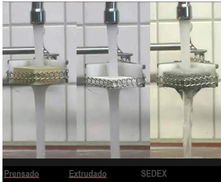
Figura1: Teste de vazão da água nos diferentes filtros, evidenciando velocidade do fluxo e retenção de escórias Fonte: Foseco Indl. Coml. Ltda.
