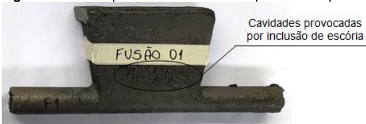
Figura 5. Blocos apresentando cavidades provocadas por inclusão de escória.
