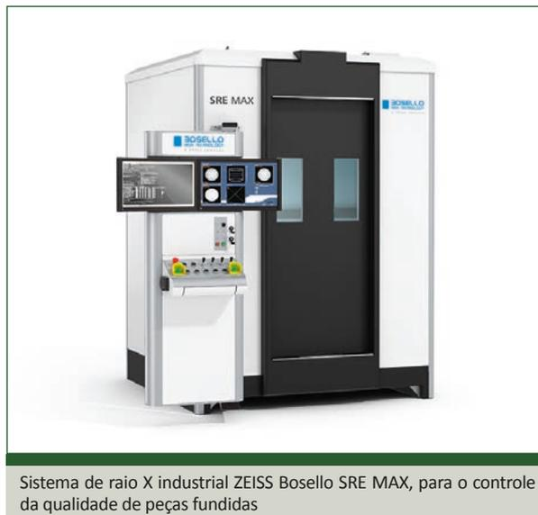
Sistema de raio X industrial ZEISS Bosello SRE MAX, para o controle da qualidade de peças fundidas
