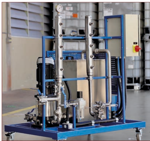
Equipamento para a limpeza de circuitos de resfriamento desenvolvido pela Chem-Trend.
