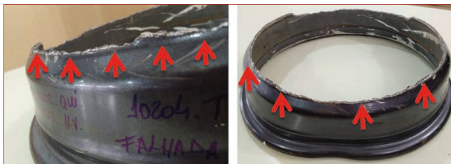
Fig. 4 – Fratura observada no raio de concordância.
