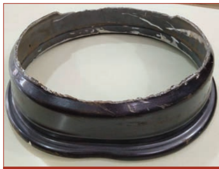
Fig. 2 – Roda de alumínio. Fratura sem deformação plástica. Abaulamento observado na roda falhada.
