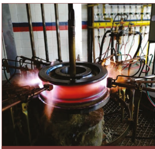
Nova linha de têmpera superficial por chamas Combustol.
