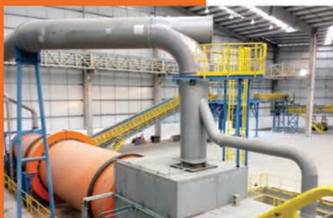
Linhas Completas de Moldagem com Desmoldagem e Exaustão
