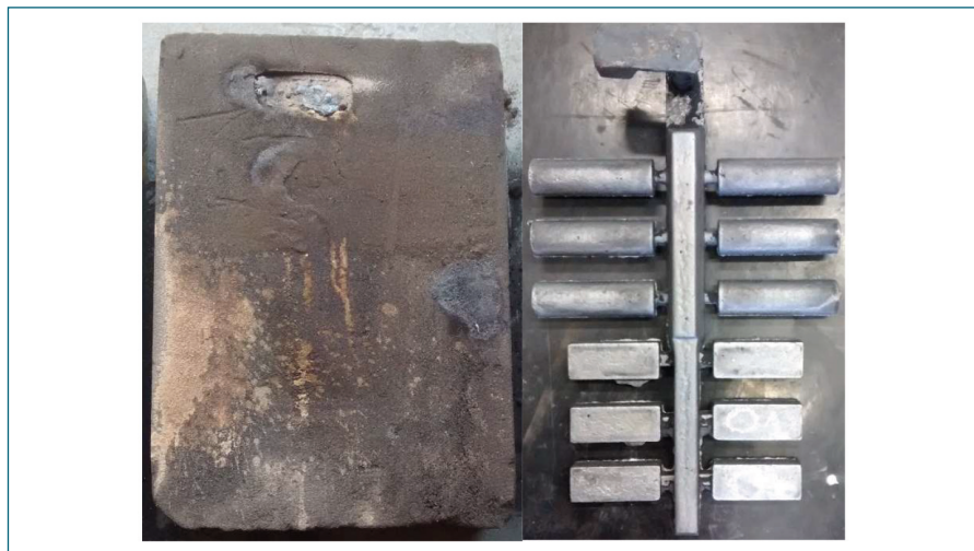
Fig. 1 – Molde em areia cura frio (PP7) e corpos de provas para ensaios mecânicos e metalográficos.
