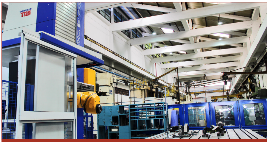
Mandriladora com capacidade para a usinagem de peças de 18 t a 25 t.
