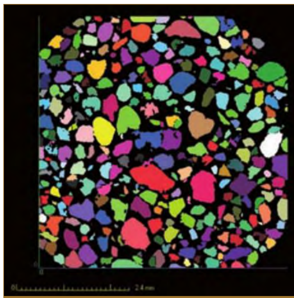
Fig. 1 – Tomografia computadorizada de uma amostra de areia.
