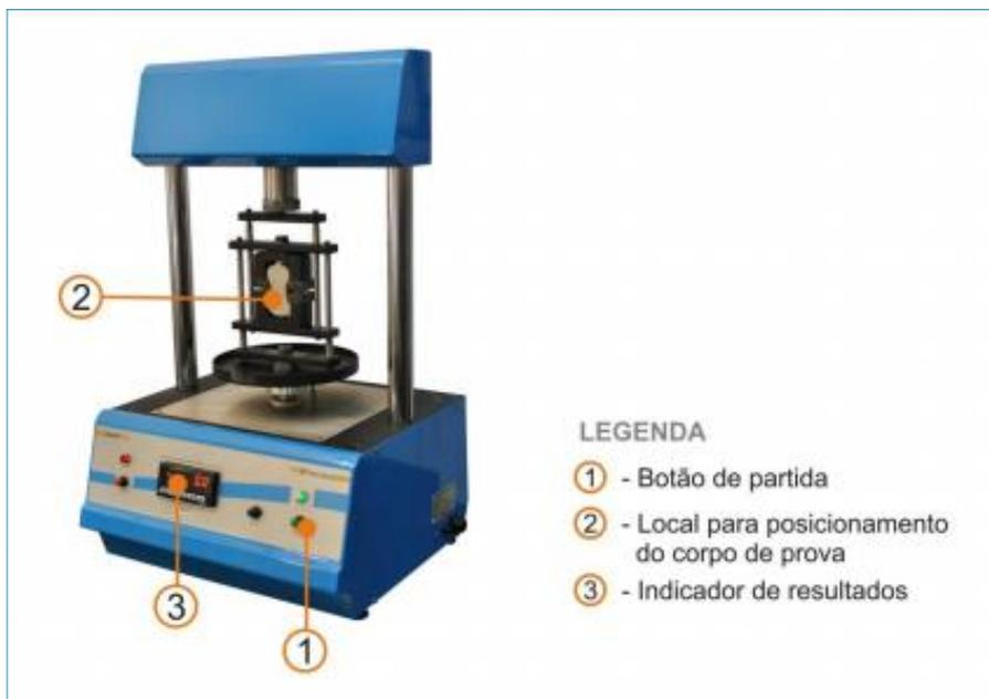
Fig. 12: Foto ilustrativa de uma máquina de resistência à tração a frio para areia coberta. Fonte: CEMP 028 p. 2. <http://www.tecnofund.com.br/cemp/normas/028.pdf>
