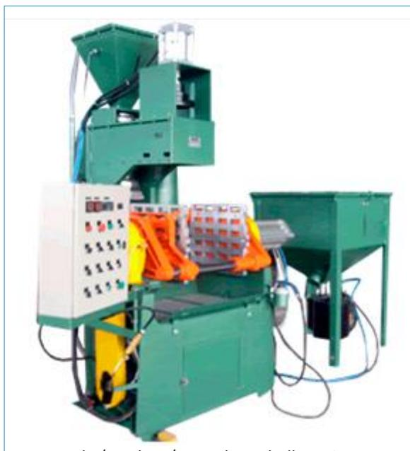
Fig. 5: Máquina sopradora para processo shell molding.
