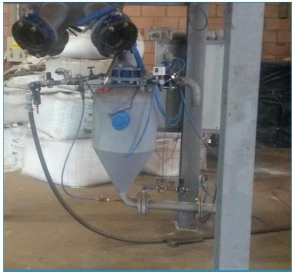
Fig. 9: Transportador pneumático cap. 100 kg. Fonte: Autor.
