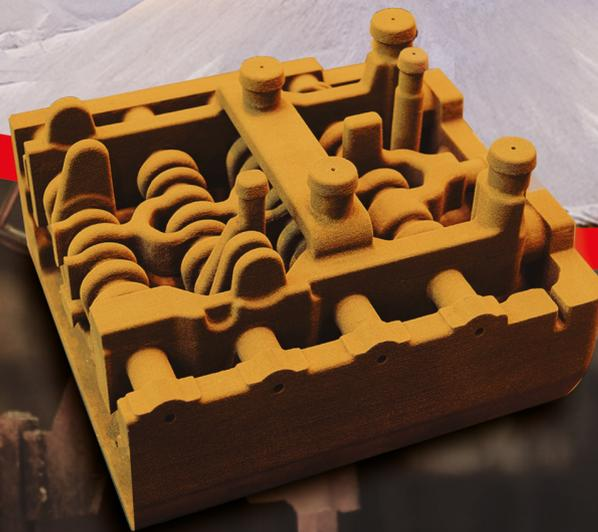
Soluções que proporcionam **estabilidade e vantagens no processo de fabricação dos moldes e machos** utilizados na fundição das peças:
