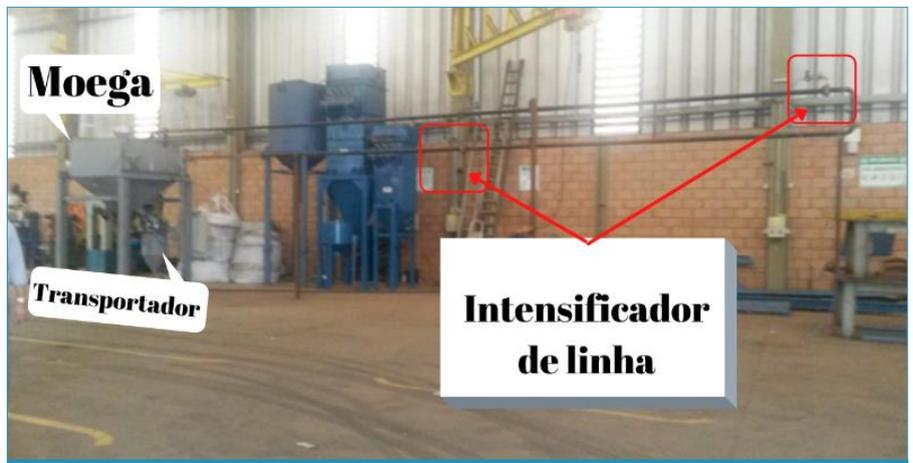
Fig. 8: Sistema pneumático montado, com detalhamento das partes integrantes. Fonte: O Autor.
